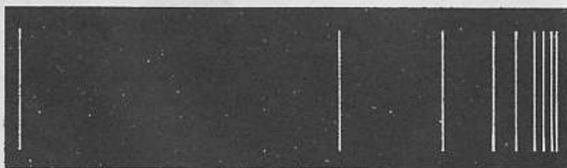
Figura 29. Espectro de emisión del hidrógeno.
